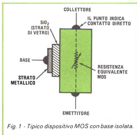
Fig. 1 - Tipico dispositivo MOS con base isolata.
