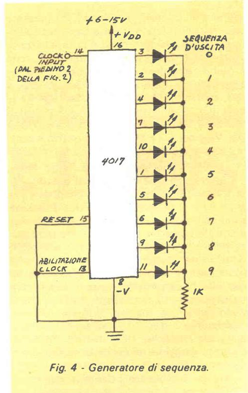
Fig. 4 - Generatore di sequenza.
