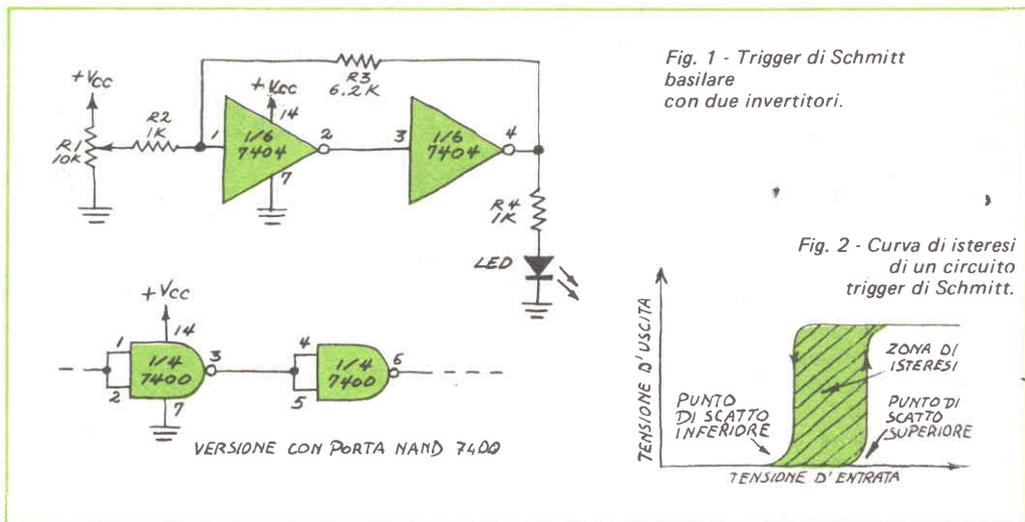
Fig. 1 - Trigger di Schmitt basiliare con due invertitori.
