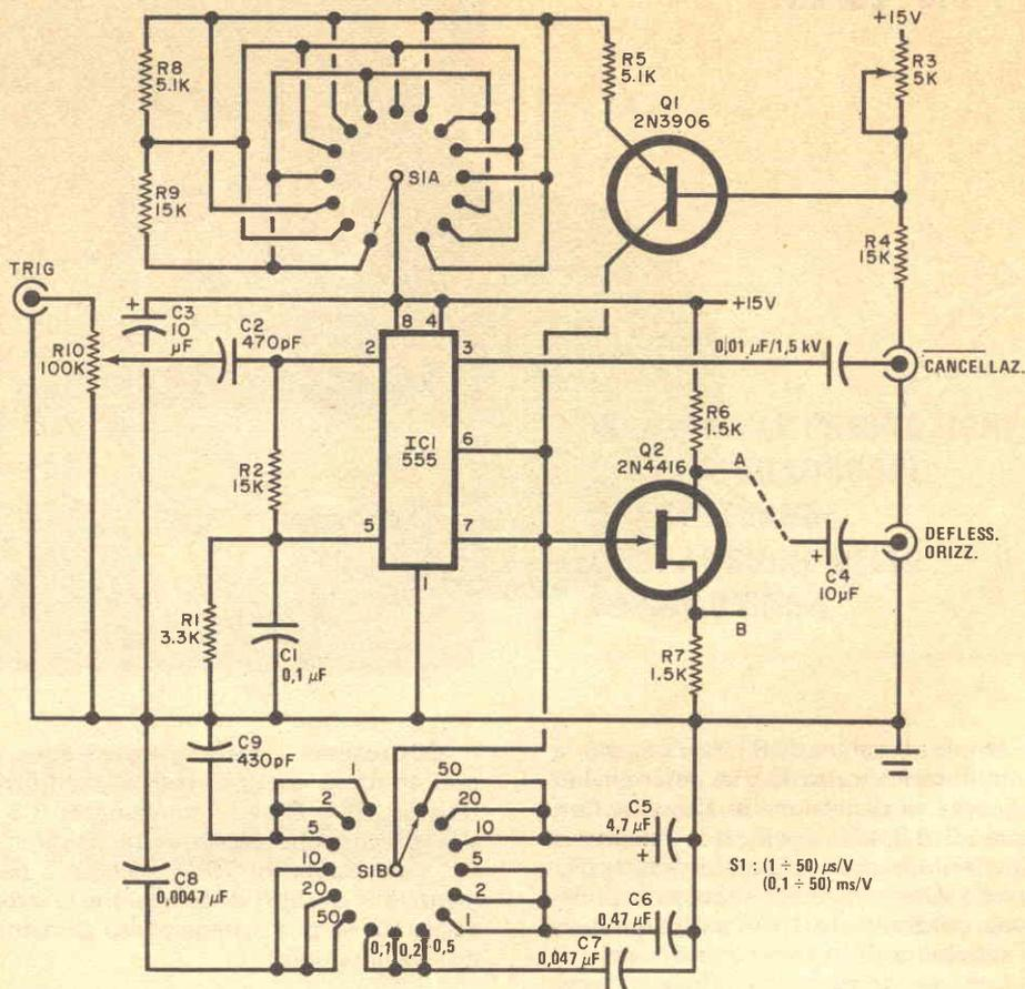
La sorgente di corrente costante Q1 ed il temporizzatore IC1 sono collegati per formare un economico circuito di deflessione orizzontale triggerata.
