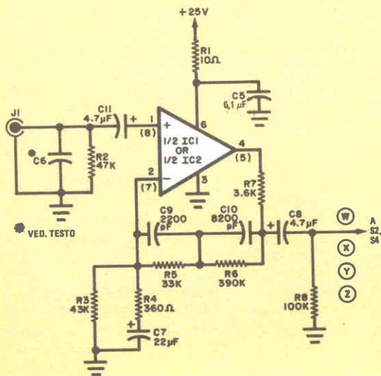
Fig. 5 - Uno dei quattro preamplificatori fono con equalizzazione IEC. Come in tutte le altre entrate, viene usato l'accoppiamento capacitivo.
