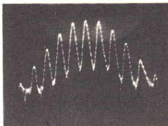
*Fig. 1 - Una portante di 100 MHz modulata in frequenza da 2 kHz.*
