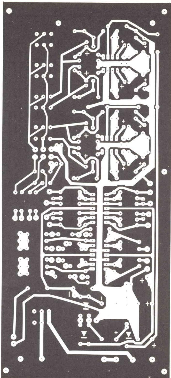
*Fig. 9 - Disegno in grandezza naturale con piano di foratura del circuito stampato del preamplificatore.*
