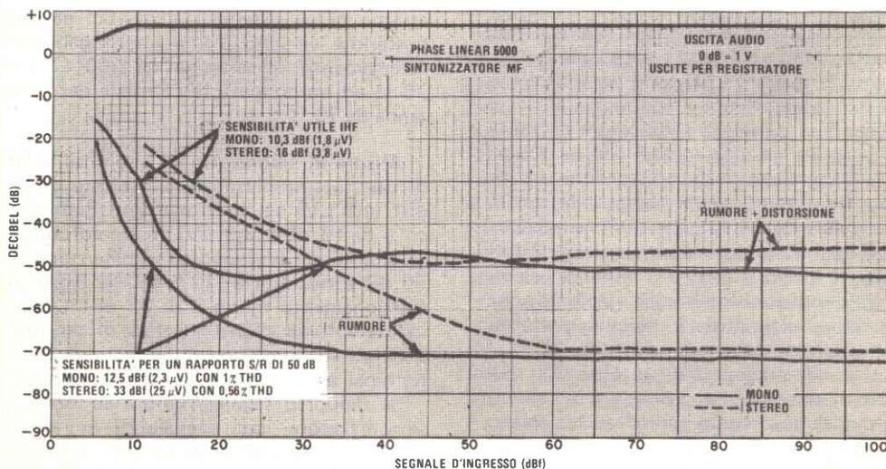
Curve di rumore e di sensibilità per il sintonizzatore
