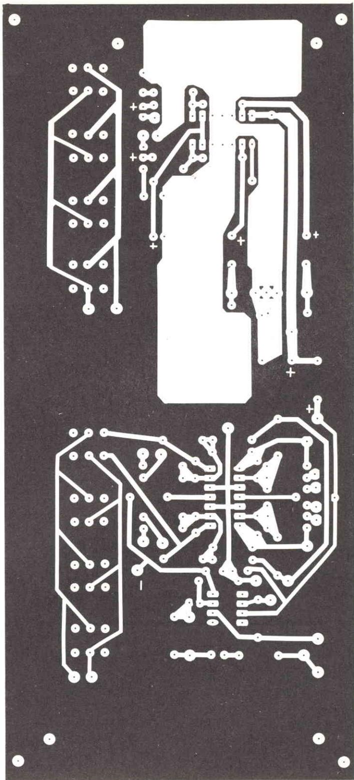
*Fig. 10 - Disegno con piano di foratura del circuito stampato del mescolatore.*
