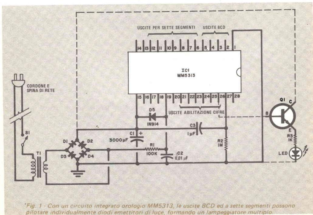
Fig. 1 - Con un circuito integrato orologio MM5313, le uscite BCD ed a sette segmenti possono pilotare individualmente diodi emettitori di luce, formando un lampeggiatore multiplo.
